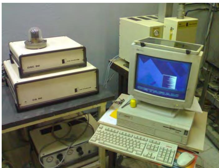
Figure V.1 Appareil de DSC utilisé
