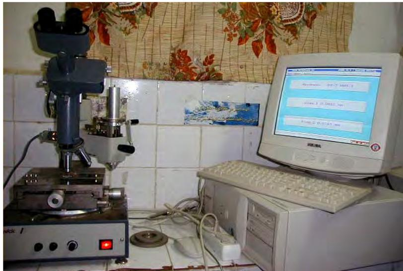
Figure V.3 Microduromètre utilisé de Type ZWICK piloté par un microordinateur.
