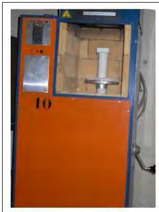
**Figure II-8** : Four utilisé pour les chauffages suivis de trempe.
