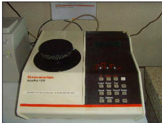
**Figure II-2** : Pycnomètre à hélium « Micromeritics Accupyc 1330 ».
