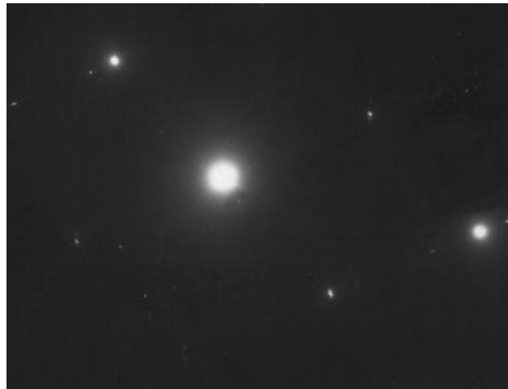
Figure III.9 : Diffraction électronique correspondant à la phase Co fcc
