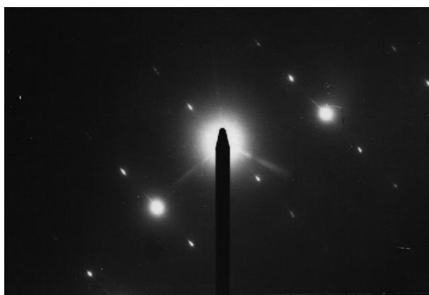
Figure III.7 : Diffraction électronique montrant seulement les taches de la phase sigma
