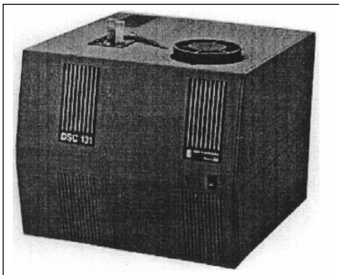
Fig. 35 : L'analyseur calorimétrique différentiel utilisé (DSC).
