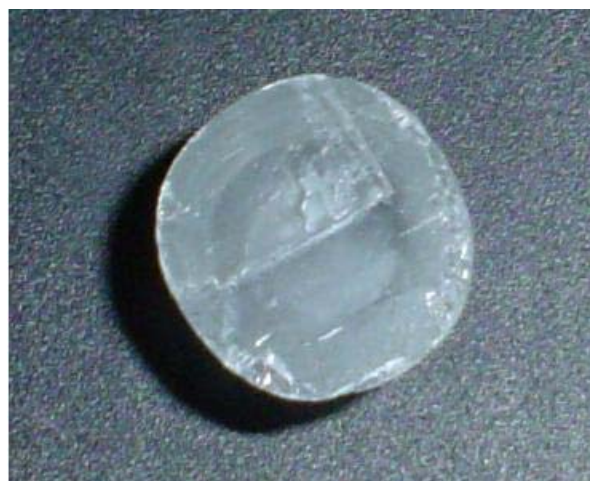
Fig. II. 3. b : Photo d'une pastille de KBr dopé par les cristallites de ZnO.
