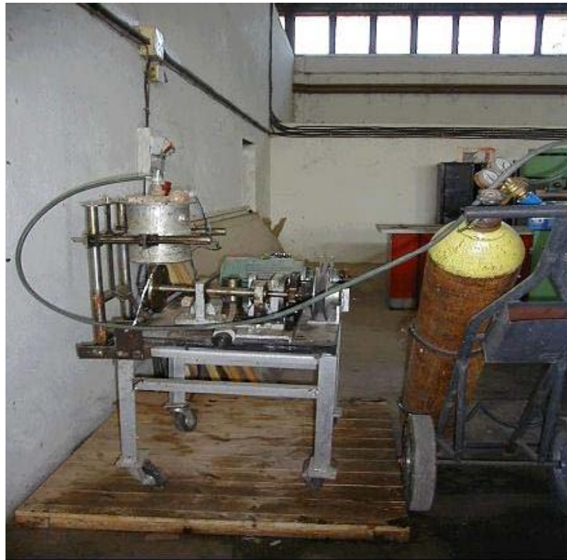
Figure III.3 : vue générale sur la machine de solidification rapide utilisée.
