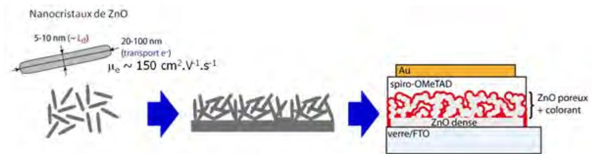
Fig. II.5 différentes étapes pour la réalisation d'une SSDSSC
