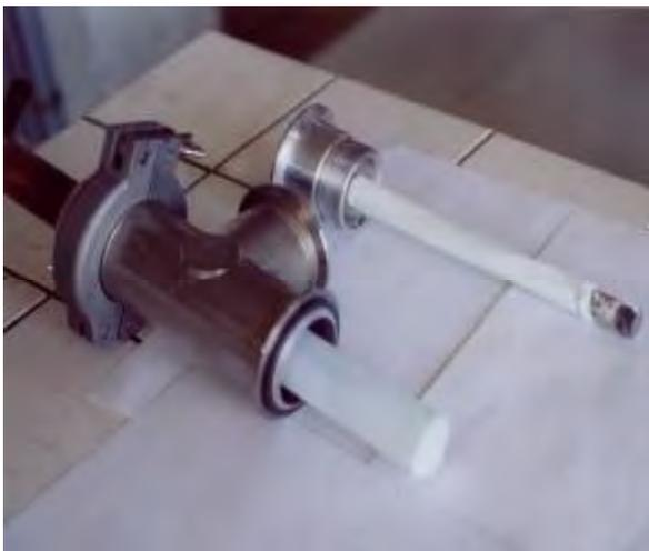
Figure (II-5a) : Vue de nanopoudres collectées sur le filtre céramique nanoporeux à droite et par condensation sur le doigt froid à gauche.
