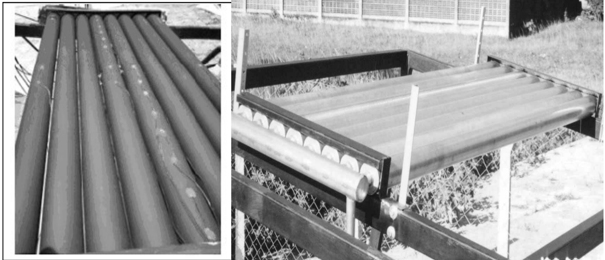
Figure V-7: Position des tubes qui forment le réacteur solaire
