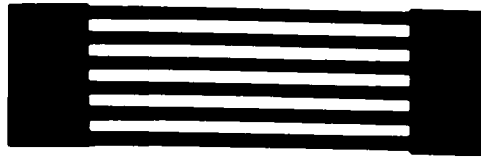
Fig.38 : Forme des "peignes" découpés par photogravure.
