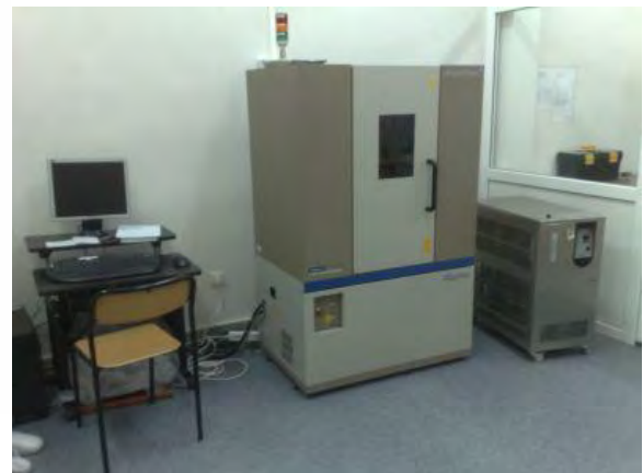
Fig. III.14 Schéma de principe et photographie de diffractomètre de l'université Abant İzzet Baysal en Turquie qui permet la mesure de spectre \theta - 2\theta par diffraction de rayons X
