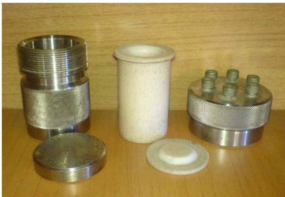
Figure 3 : Autoclave locale de 23 ml de fabrication locale.
