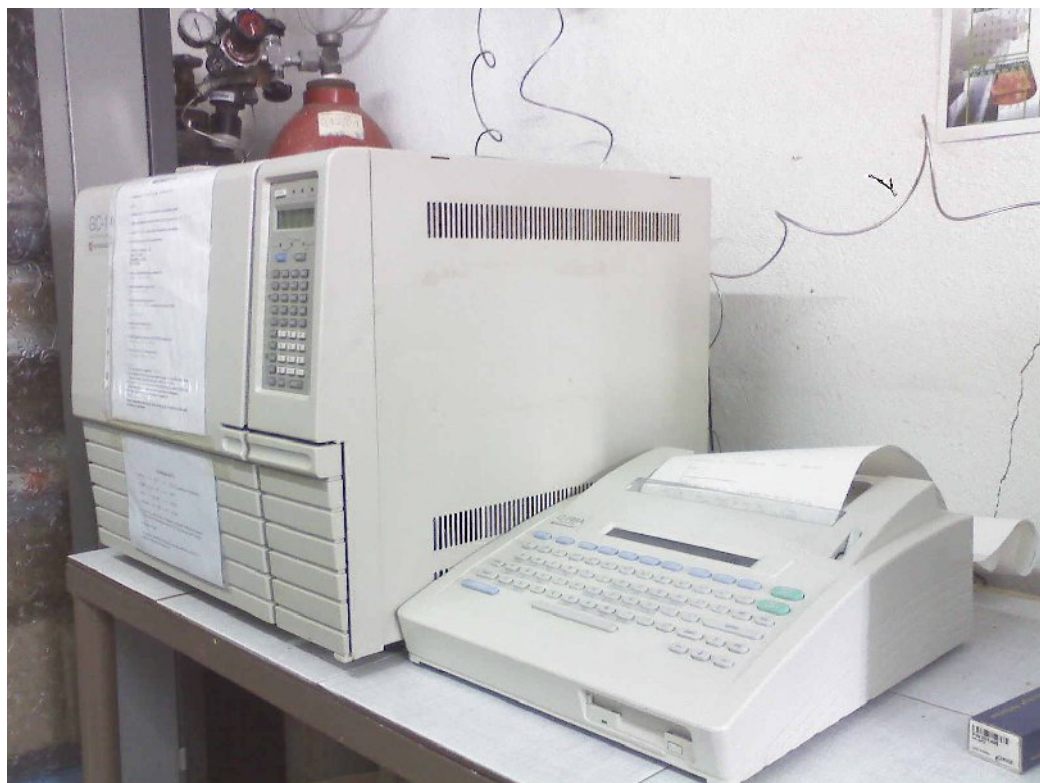
Figure 11. Chromatographe SCHIMADZU DE TYPE GC-17A combiné à une colonne capillaire de type DB-5 (0,25mm D.I×30 m) et un détecteur FID.
