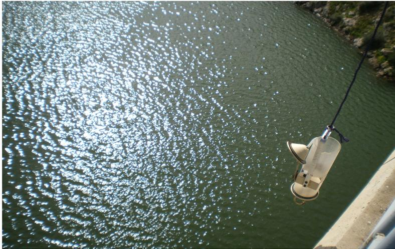
**Figure III.1. Prélèvement des échantillons d'eau au niveau de la digue**
