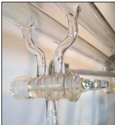
Figure 9 : robinet à trois voies
