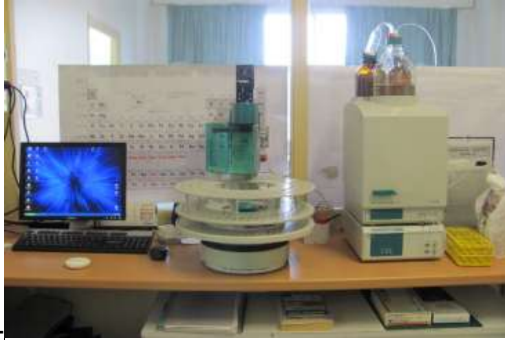
Figure 33: Appareil d'analyse de chromatographie ionique 861 Advanced compact IC .
