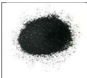
Figure 65: Charbon actif préparé par carbonisation.
