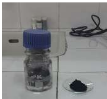
Figure 66: Charbon actif préparé par activation chimique.
