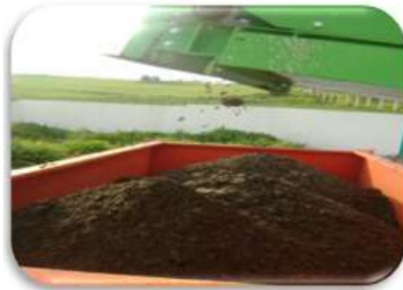
Figure 30: Prélèvement des boues de la station de Sidi Merouane à la sortie du filtre à bande.
