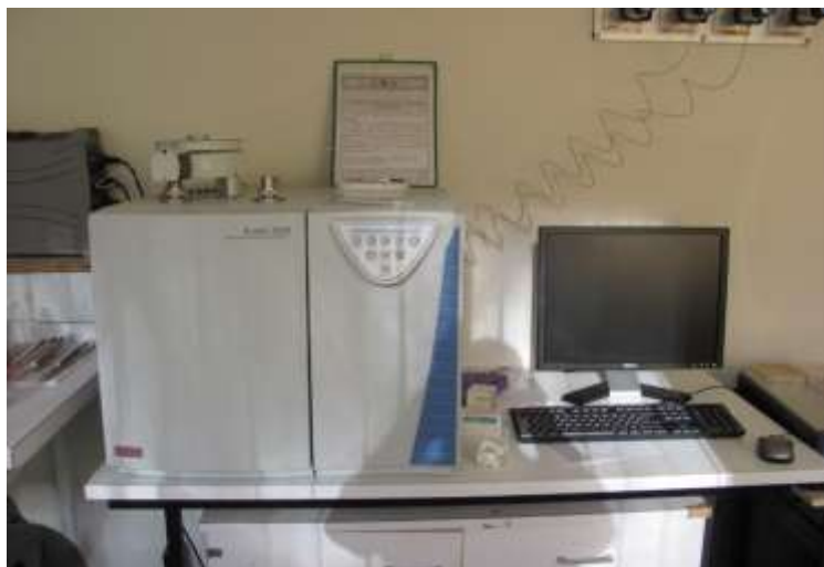
Figure 34: Appareil d'analyse élémentaire (C et N) FLA-2000 .
