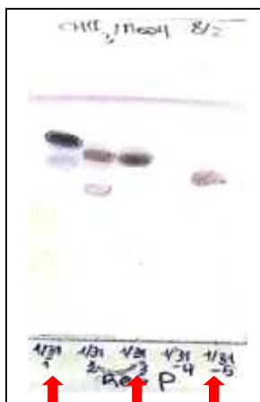
Figure II.11. Plaque CCM de la séparation de la fraction Rsa31 révélée à l'acide sulfurique
