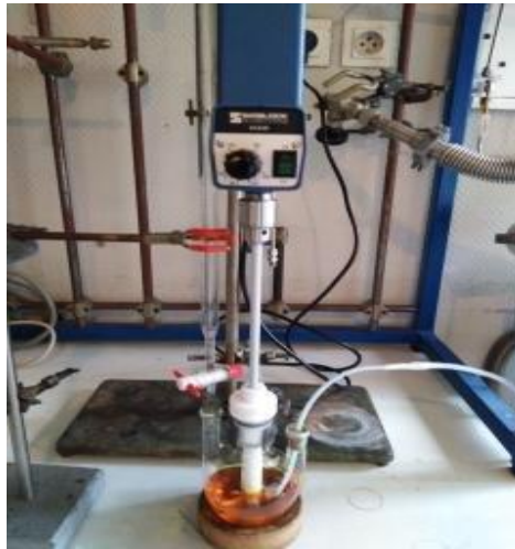
Figure 113: Montage expérimental de la préparation du fer zéro valent sous agitation mécanique
