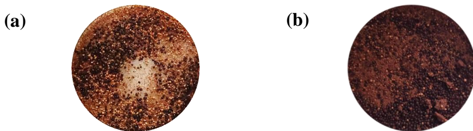
Figure 47: Photos des composites Fe(III)-Amberlite IRN150 préparés par précipitation (a: sous agitation magnétique; b: dans le bac à ultrasons (38 kHz))
