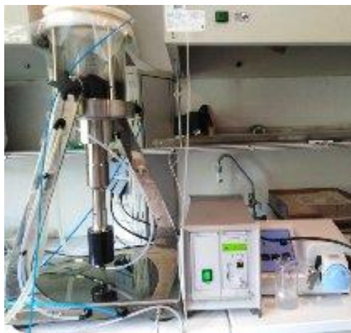
Figure 115: Montage expérimental de la préparation du fer zéro valent dans le réacteur cup-horn (20 kHz)
