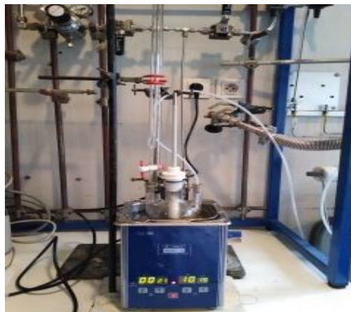
Figure 114: Montage expérimental de la préparation du fer zéro valent dans le bac ultrasons (38 kHz)
