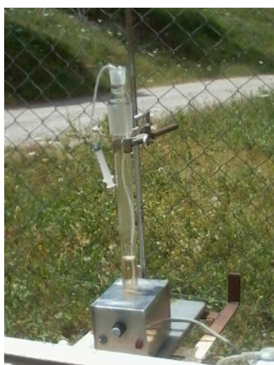
Figure II.6 : Montage expérimental du système d'irradiation solaire.
