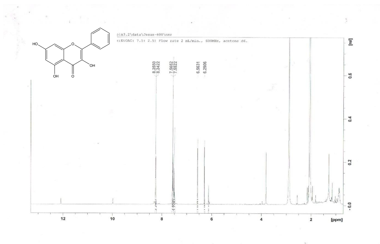
Figure-57 : Spectre RMN- 1 H (600 MHz, acétone d-6, \delta ppm) du composé PCA4
