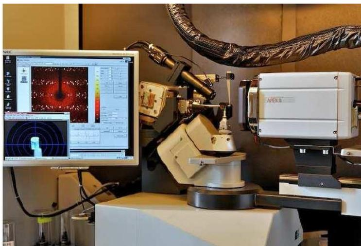
Figure-1: *Diffractomètre automatique Bruker Apex II*
