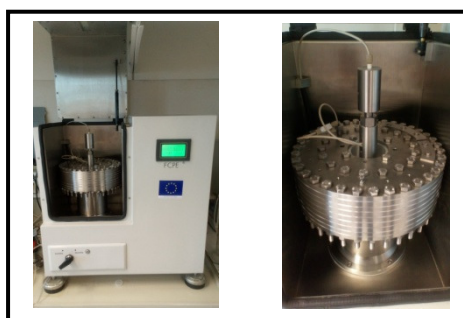
Figure II-02. Appareil de l'extracteur de partage centrifuge disponible dans le laboratoire.
