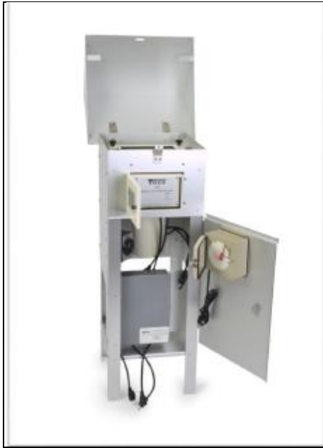
Figure 17. Echantillonneur de PM 10 HVS TE- 6070
