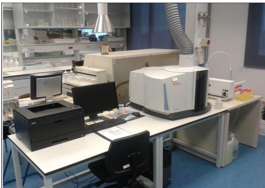
Figure 26. Spectromètre d'émission à plasma à couplage inductif Thermo Fisher Scientific ICAP650
