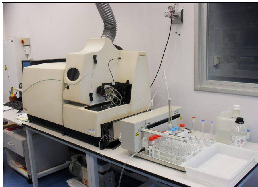
Figure 25. Spectromètre de masse à plasma à couplage inductif ICP-MS (Thermo Fisher Scientific X-Series II)
