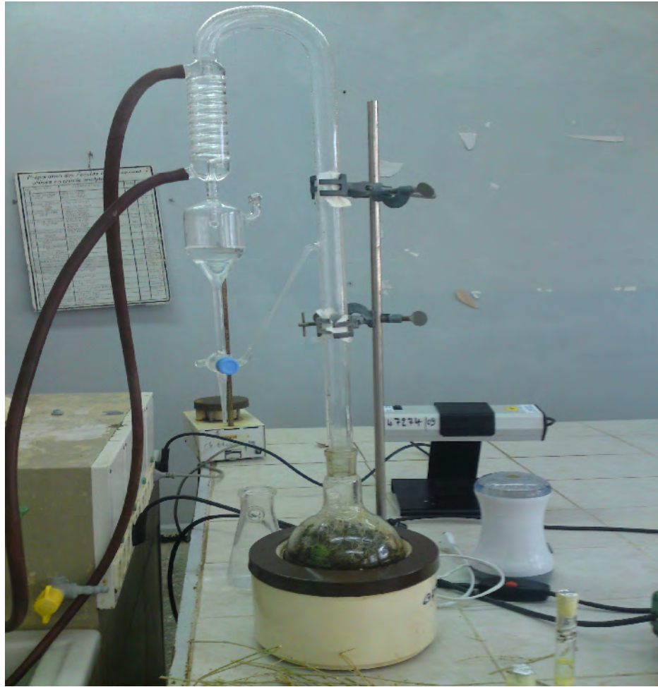
Figure 18: Montage d'une unité d'hydrodistillation
