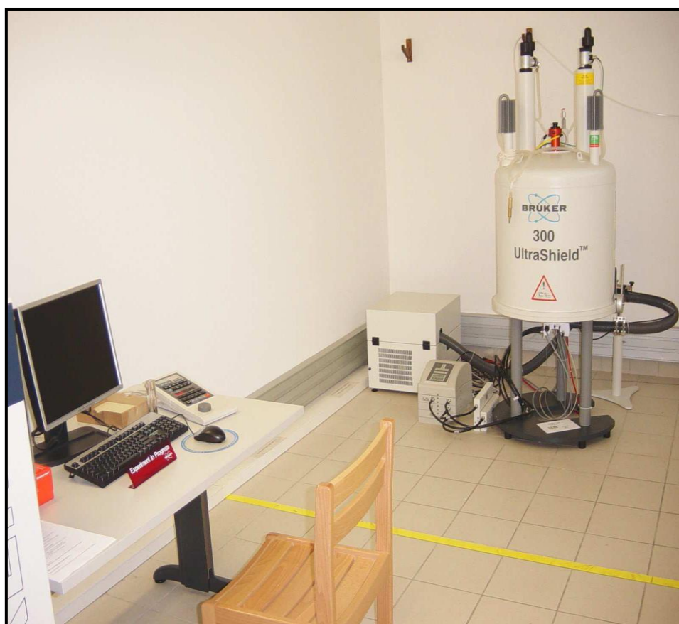
Figure 5: Bruker DPX300, tête de mesure ATMA observation BB ( ^{19}\text{F} - ^{15}\text{N} ), découplage. ^1\text{H} , diam. 5 mm. Tête de mesure observation ^1\text{H} , découplage BB ( ^{31}\text{P} - ^{109}\text{Ag} ), diam. 5 mm. Système de variations de température contrôlé par ordinateur.
