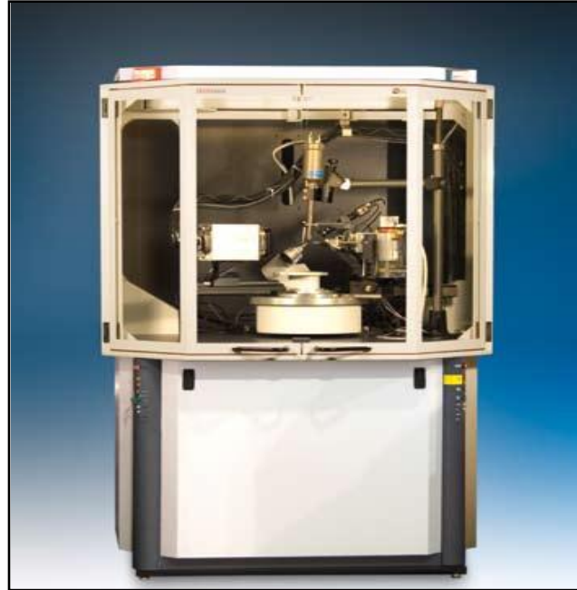
Figure 2: Diffractomètre Bruker APEX II , diffractomètre quatre cercles (géométrie Kappa) à détecteur bidimensionnel de type CCD (APEX II). Equipement basse température azote liquide : Cryostream (Oxford Cryosystems) permettant d'atteindre les 90 K.
