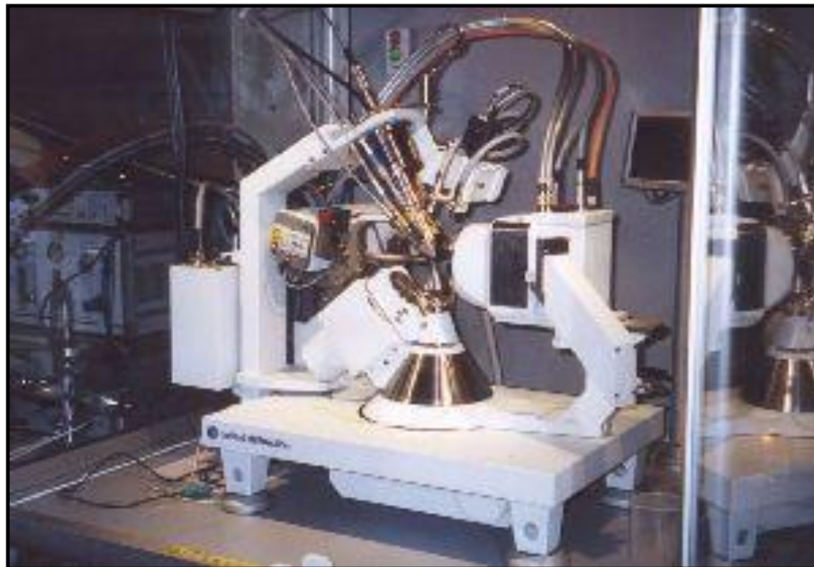
Figure3 : Diffractomètre Agilent-Technologies Gemini , diffractomètre quatre cercles (géométrie Kappa) à détecteur bidimensionnel de type CCD (EOS), double anode Cu et Mo. Equipement basse température azote liquide : Cryojet (Oxford Instruments) permettant d'atteindre les 90 K. Equipement basse température hélium : Helijet (Oxford Instruments) permettant de descendre jusqu'à 15 K.
