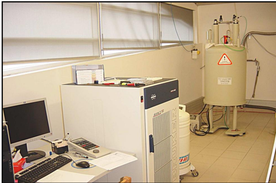
Figure 6 : Bruker Avance 400 , tête de mesure observation ^1\text{H} , découplage double accord \text{BB}(^{31}\text{P}-^{103}\text{Rh})/^{31}\text{P} avec gradient de champs Z, diam. 5 mm. Tête de mesure observation \text{BB}(^{31}\text{P}-^{103}\text{Rh}) découplage ^1\text{H} avec gradient de champs Z, diam. 5 mm. Tête de mesure observation \text{BB}(^{31}\text{P}-^{103}\text{Rh}) découplage ^1\text{H}/^{31}\text{P} , diam. 10 mm. Système de variations de température contrôlé par ordinateur.
