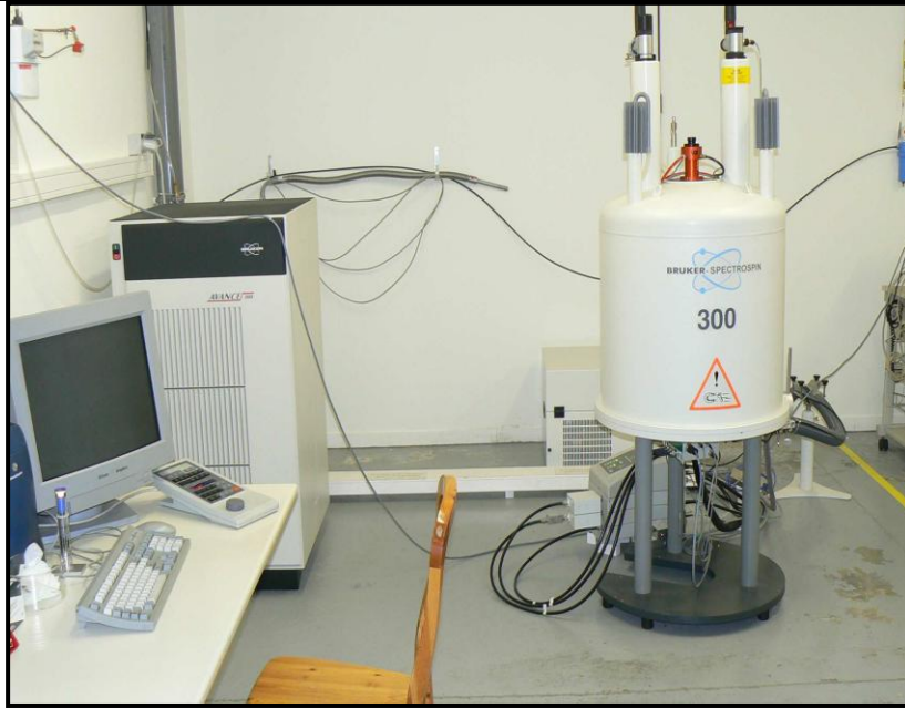
Figure 5: Bruker Avance 300 Tête de mesure observation ^{13}\text{C} , découplage ^1\text{H}/^{31}\text{P} , diam. 5 mm. Tête de mesure observation ^1\text{H} , découplage ^{13}\text{C}/^{31}\text{P} , diam. 5 mm. Système de variations de température contrôlé par ordinateur.
