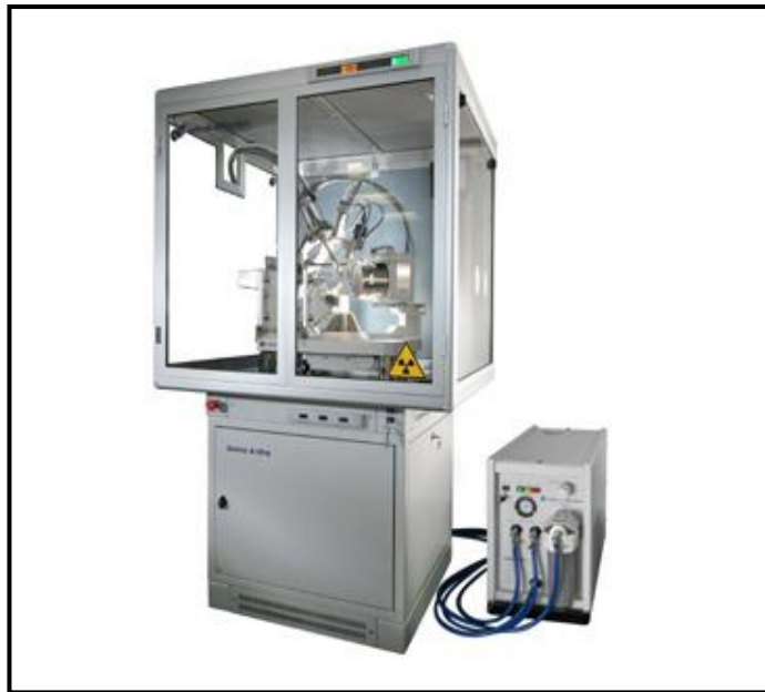
Figure3 : Diffractomètre Agilent-Technologies Gemini , diffractomètre quatre cercles (géométrie Kappa) à détecteur bidimensionnel de type CCD (EOS), double anode Cu et Mo. Equipement basse température azote liquide : Cryojet (Oxford Instruments) permettant d'atteindre les 90 K. Equipement basse température hélium : Helijet (Oxford Instruments) permettant de descendre jusqu'à 15 K.
