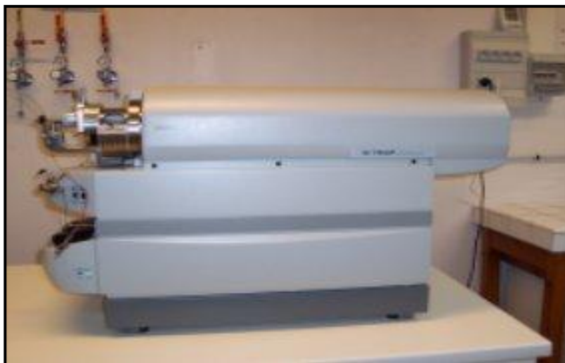
Figure 7: Spectromètres MS/MS API-365 (Perkin Elmer Sciex) et Q TRAP (Applied Biosystems) équipés des sources Electrospray (ESI) et Atmospheric Pressure Chemical Ionization (APCI). Possibilité d'analyses jusqu'à m/z 3000, MS/MS (ions fragments, précurseurs et perte de neutre), LC/MS, LC/MS/MS et dosage
