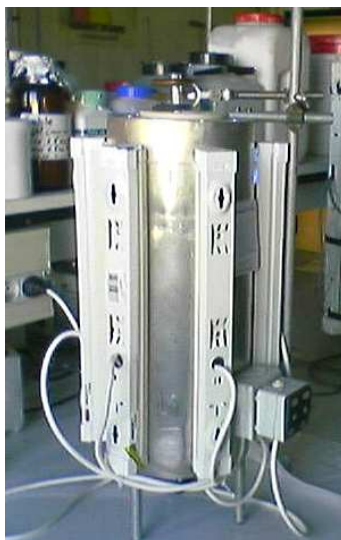
Figure I. 3 : Dispositif d'irradiation polychromatique (300 - 450 nm)
