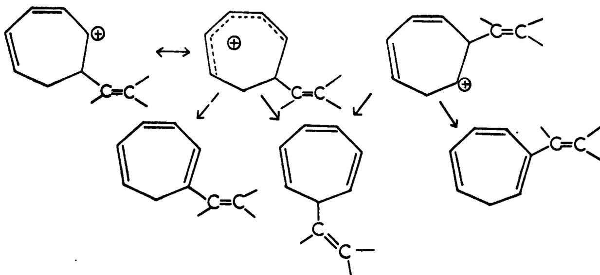
Fig. III,7 - Mécanisme de formation des alcényl-tropilidènes
