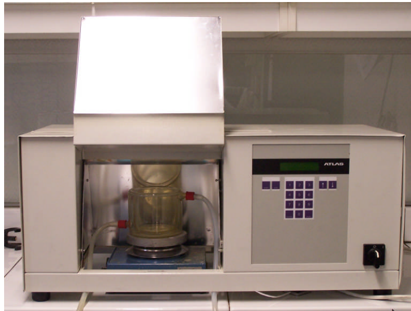
Figure II.1: Schéma du montage utilisé en photocatalyse (Suntest + réacteur)
