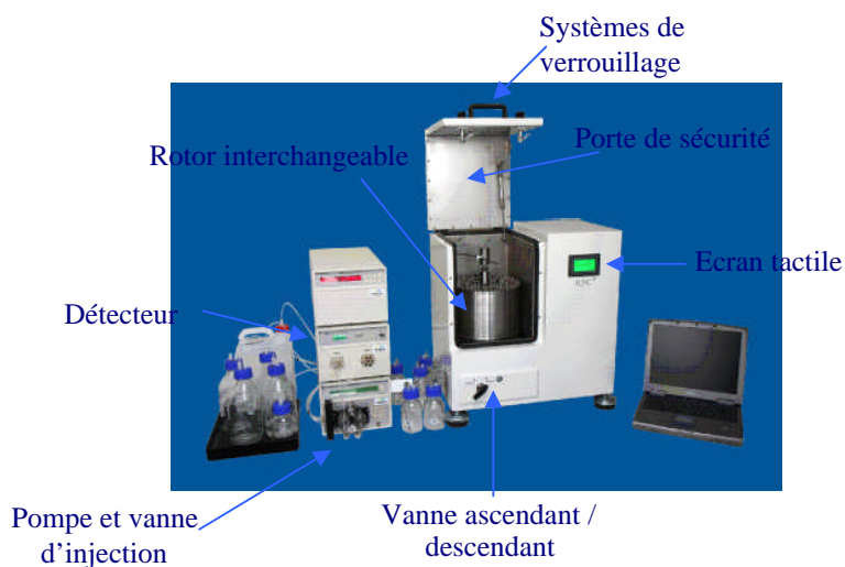
Figure II. 6 : Schéma et photo du banc chromatographique de la CPC.
