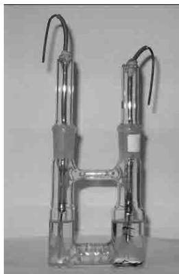
**Figure 50** : Cellule d'électrocristallisation
