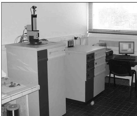
**Figure 42** : Magnétomètre à détecteur SQUID.
