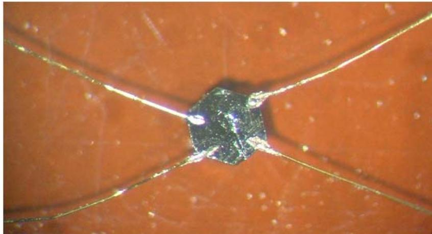
Figure I-4 : Dispositif de mesure de la conductivité électrique
