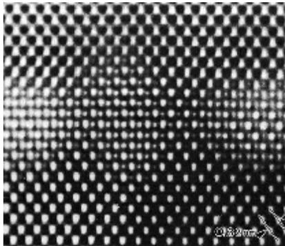
**Figure 4 :** micrographie haute résolution germanium-silicium
