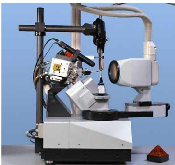
**Figurte2 : la tête goniométrique d'un Kappa CCD**
