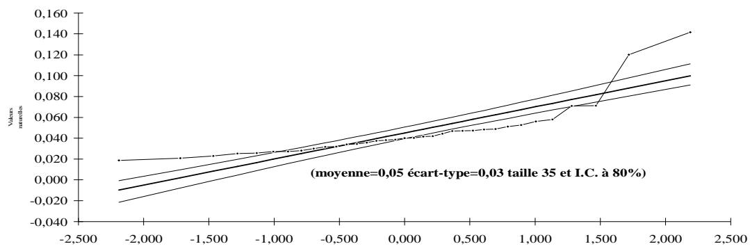
شكل رقم 24 محطة عين زادة : التعديل الاحصائي لصيغات النضوب بقانون GAUSS للفترة (04/05\_70/71)
