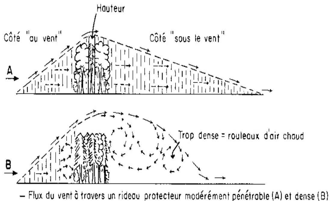
**Figure n°3-6:** Influence d'un brise-vent sur le vent
