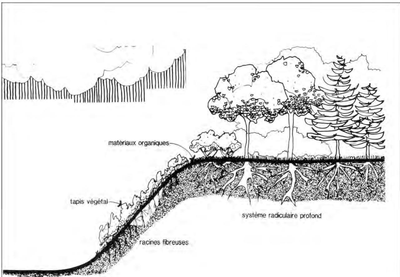
**Figure n°1-7: Contrôle de l'érosion par la végétation<sup>5</sup>**
