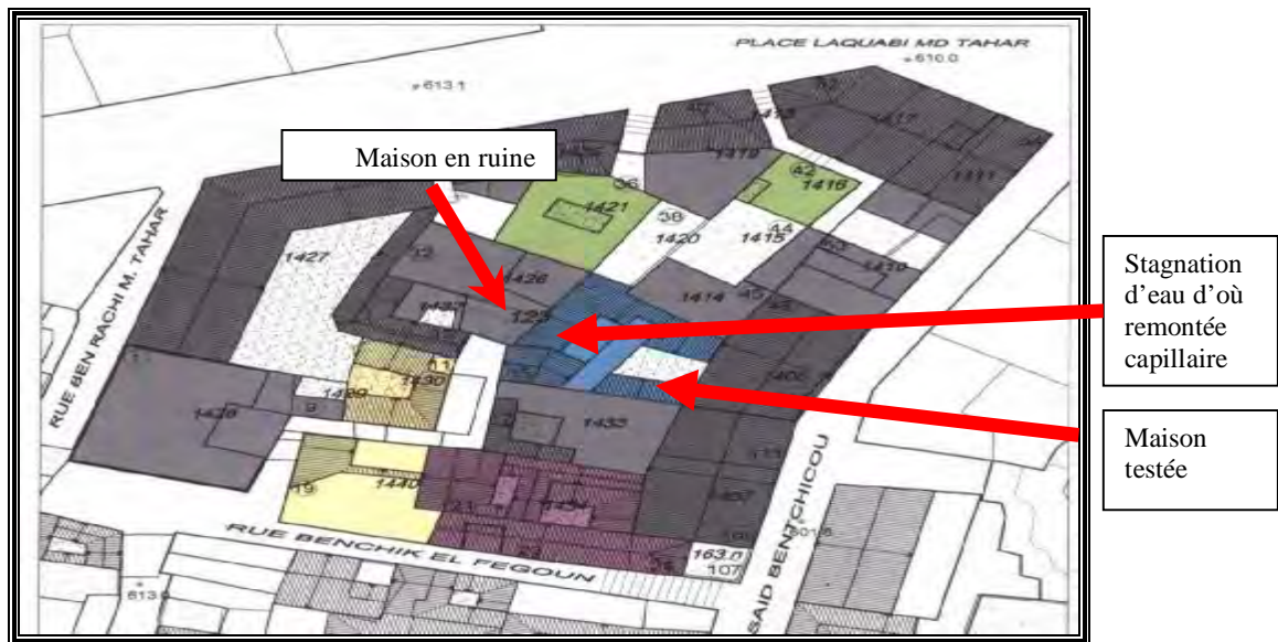
Fig.6-84 : plan de masse, origine des sources d'eau souterraine. Stagnation des eaux pluviales au niveau des ruines provoquant des remontées capillaires. Source : auteur, 2004
