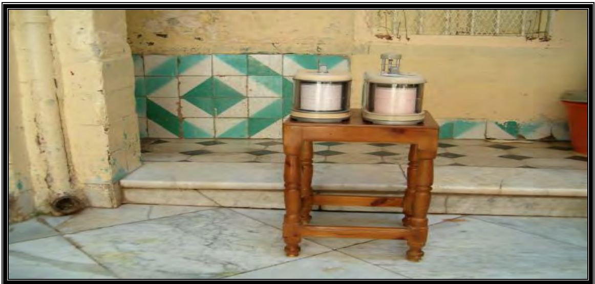
Fig.6.61 : emplacement des appareils de mesures à l'extérieur de la chambre (galerie), Thermographe et hygromètre (Jules Richards. Aluvac-20-124). Mesure de température de l'air et humidité relative, horaire, enregistrement des valeurs respectivement, (0°C – 50°C) et (0% - 100%). Source : auteur, 2004
