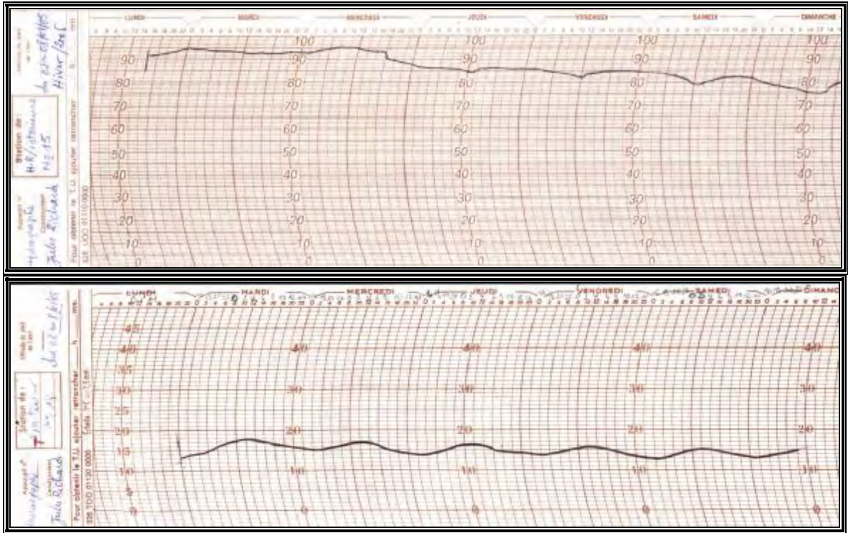
Mesures de températures et d'humidités relatives à l'intérieur de la chambre et à l'extérieur (Galerie/patio)d'une maison vernaculaire. Médina de Constantine, période: 27juillet au 03août 2004
