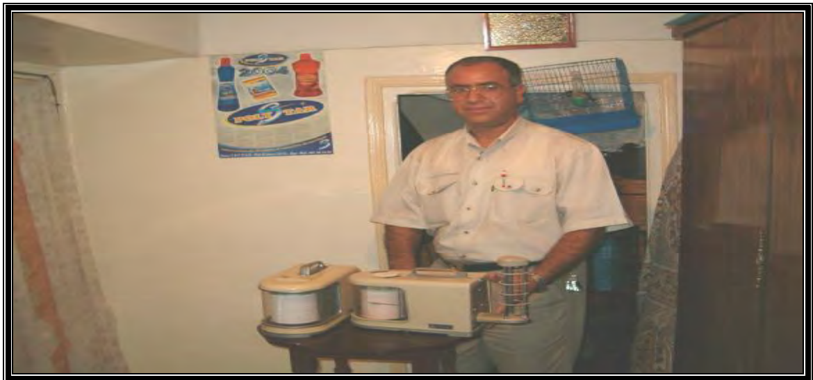
Fig.6-60 : emplacement des appareils de mesures à l'intérieure de la chambre, Thermographe et hygromètre (Jules Richards. Aluvac-20-124). Mesure de température de l'air et humidité relative, horaire, enregistrement des valeurs respectivement, (0°C – 50°C) et (0% - 100%). Source : auteur, 2004
