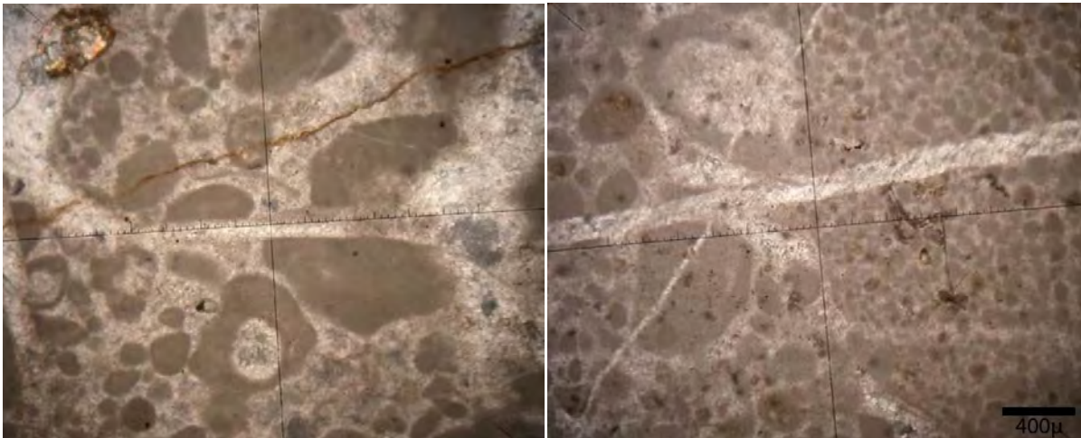
Figure 23: Grainstone (Pelsparite) à éléments de taille irrégulière.
