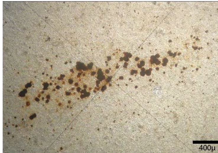
Figure 61: Mudstone montrant un regroupement de grains arrondis d'oxydes de fer.
