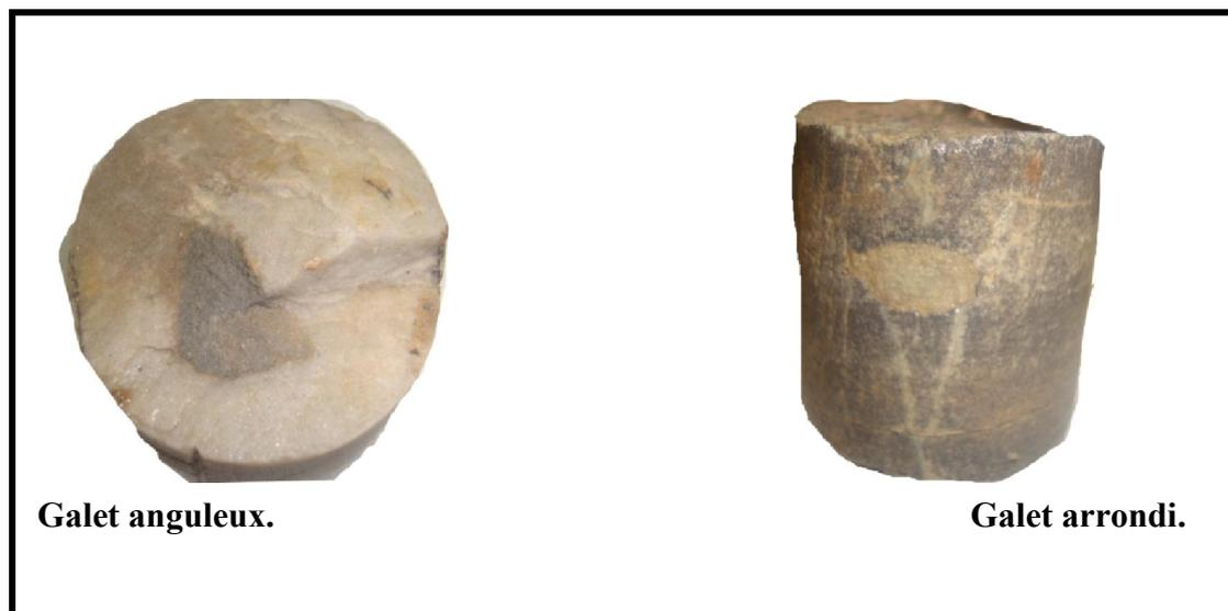
Photo 02 : figure montrant des Carottes avec des Galets d'argile.
