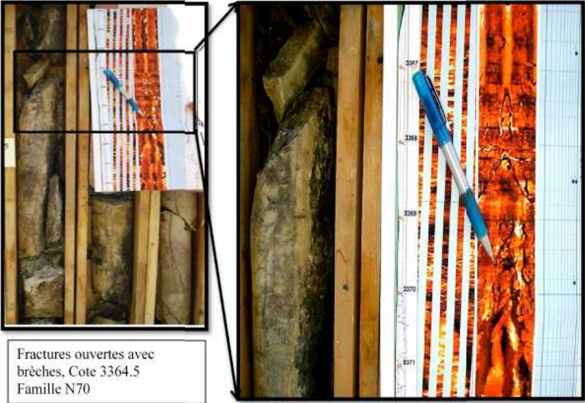
Fig. 48 : puits HTF6, extrait du Quick-look analysé de Schlumberger.
