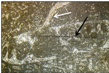
**Mph.3:** Microfaciès EXP4, fragments de test de rudiste (flèche blanche), bryzoaires (flèche noire), a et b deux sections différentes (A2, LN, X 2,5 (X1, 25))
