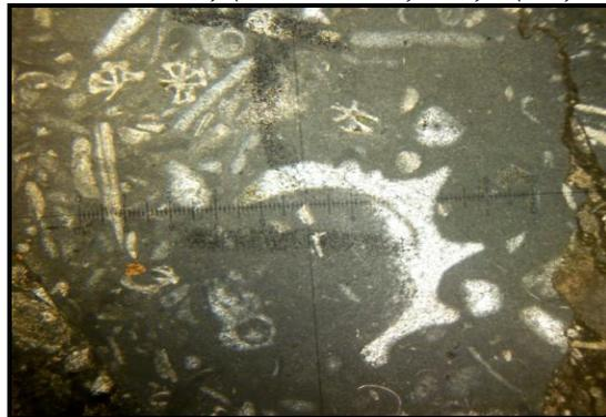
*Mph.4: Microfaciès CG2, microconglomérats à ciments argilo-carbonaté, fragment de calcaire, biomicritique à gastéropodes (BC 1.5 LN, X 2,5 (X1, 25))*
