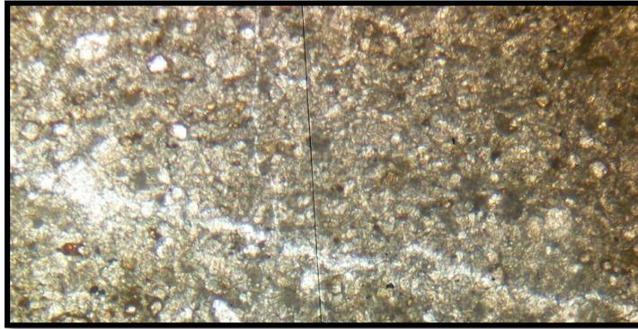
***Mph.11: Dolomitisation : dans le coin haut à gauche apparaissent des cristaux subhémisphériques entourés d'une enveloppe d'oxydes de fer témoignant de dolomitisation, (YC LP, X 10X1, 25))***
