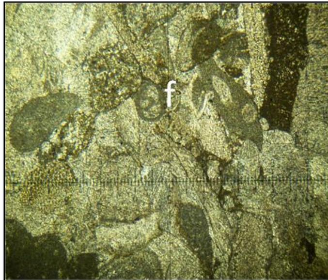
**Mph.2: Microfaciès EXP7 : grainstone, biomicrosparite à bivalves et fénestelles (BC 1.4, LN, X 2,5 (X1, 25))**
