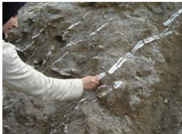
**Photo.04:** Le remplissage de gypse fibreux dans l'encaissant argileux du gisement de Grarem-ouest
