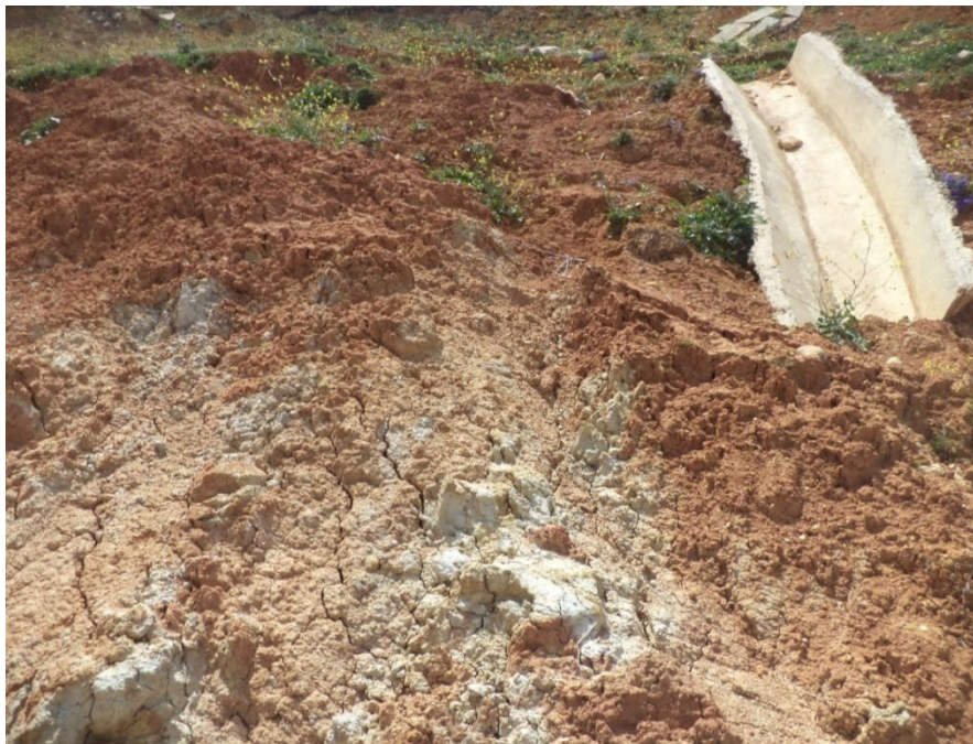
Photo III.4 : Affleurement du gypse dans les argiles de Trias sur un versant instable ; 36°8'48,3"N et 7°48'44,49"E/ RN 81 ; PK : 81+100.
