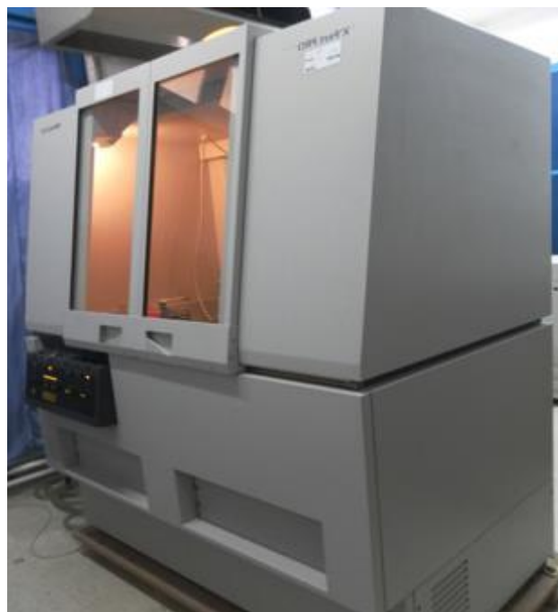
Figure 53 Diffractomètre aux Rayons X de système XPert-PRO (Laboratoire Université El Manar, Tunis).
