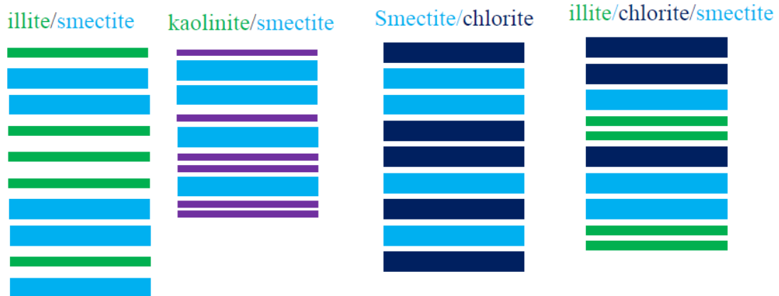
Figure 10. Différentes possibilités d'interstratification au sein des minéraux argileux avec deux ou trois composants (MACHE, 2013).
