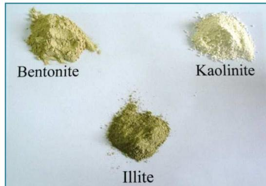
Photo 2-2 : les trois argiles utilisées pour la confection des échantillons
