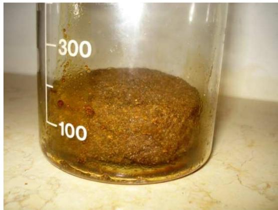
Photo 2-3: échantillon après saturation en pétrole
