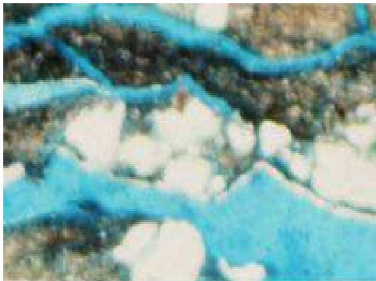
Figure 1-9 : Fractures ouvertes vues au microscope, bien illustrées par le bleu de méthylène, échantillon pris en mer du Nord ( $1\text{ cm}=193\ \mu\text{m}$ ), (Benzagouta et al, 2001)
