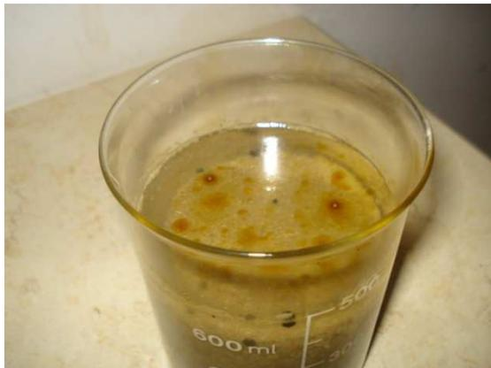
Photo 2-4: immersion de l'échantillon dans l'eau
