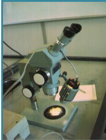
Figure 2-8 : La morphoscopie par la loupe binoculaire pour la détermination de la forme des grains
