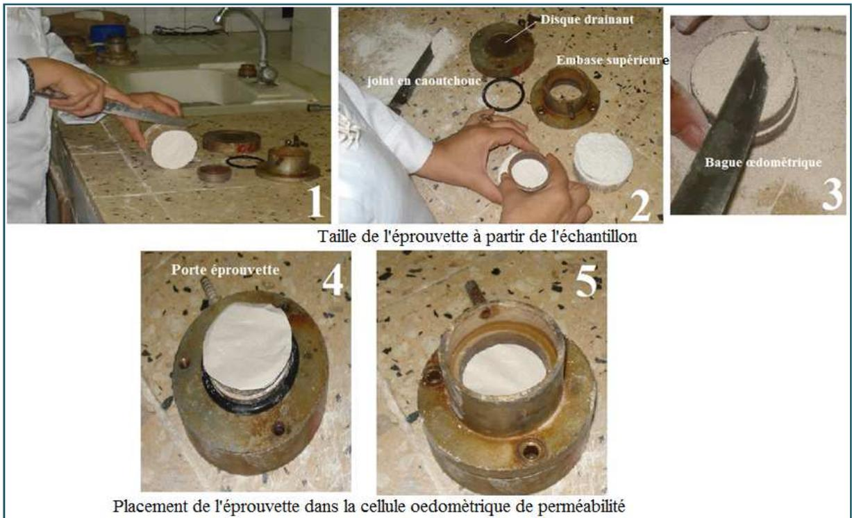
Figure 2-17 : Etapes de la préparation de l'éprouvette d'échantillon nécessaire pour la réalisation des mesures de perméabilité
