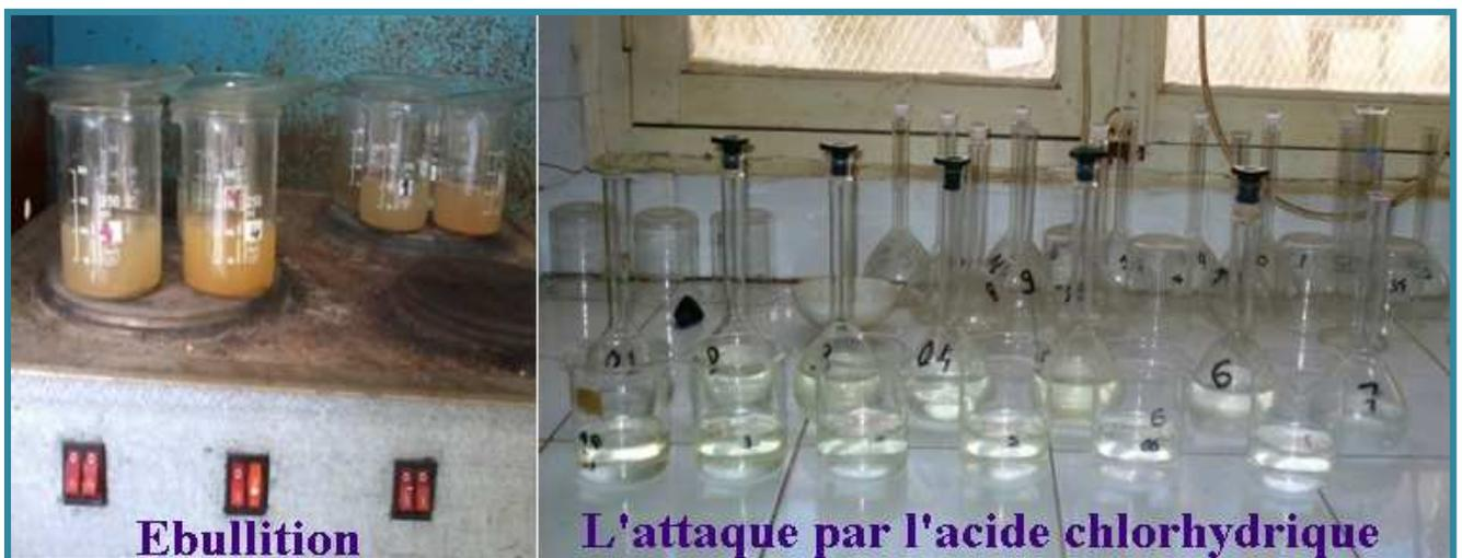
Figure 2-5 : Le dispositif utilisé pour la détermination des éléments insolubles
