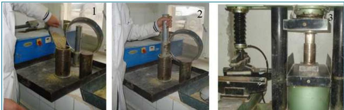
Figure 2-13 : Procédure de consolidation des échantillons
