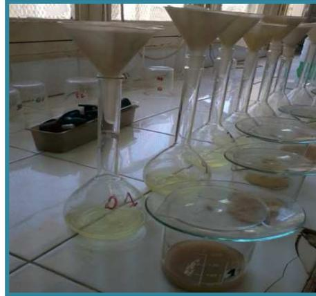
Figure 2-6 : Le dispositif utilisé pour la détermination des sulfates
