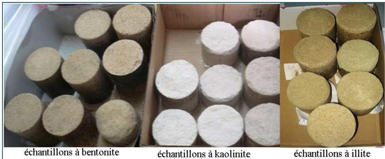
Figure 2-15 : Aspect de quelques échantillons suites à leur consolidation
