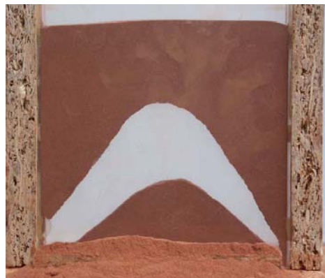
Figure 26 Arc de sable auto stable ; expérimentation de Hugo Houben. Grains d'Isère 2004) source : carterre
