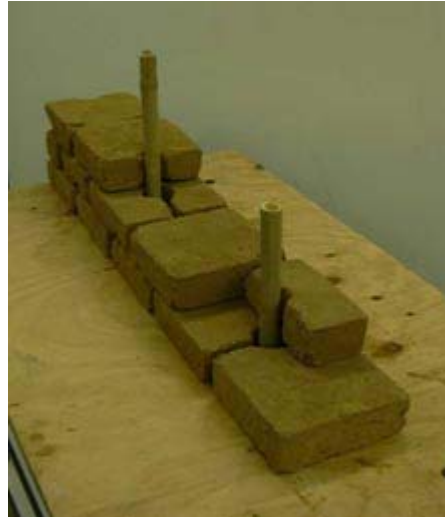
Figure - 76 spicemen, renfort attaché à l'exterieur
