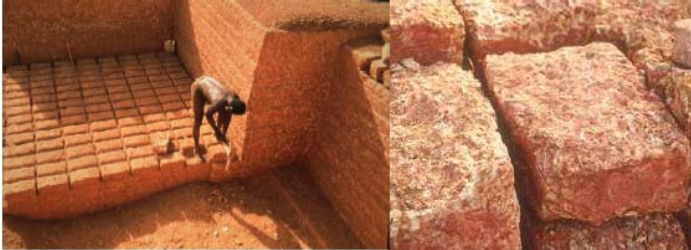
Figure 70 Plinthite découpée en bloc in situ. Et stocke a l'air libre pour durcissement source ( doctorat romain anger)
