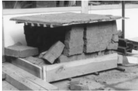
Figure 82 résultats des essais sur un modèle de forme carrée source (Construction manual for earthquake resistant houses built of earth) gernotminke
