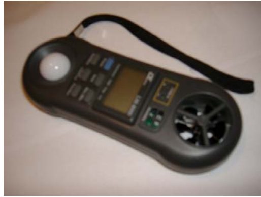
Figure 103 Multimètre & thermomètre utilisés pour mesurer les températures (intérieure et extérieure), surfaciques et la température de l'air.
