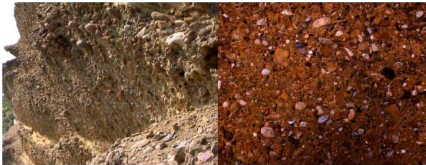
Figure 69 Photo1.1: Molasse : conglomérat de cailloux, graviers, sables agglomérés par un liant carbonaté. Source ( doctorat romain anger ) Photo1.2: Détail d'un mur en pisé.
