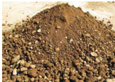
Figure 25 Ségrégation dans un tas de terre (source : grains de bâtisseurs) , publication craterre 2004
