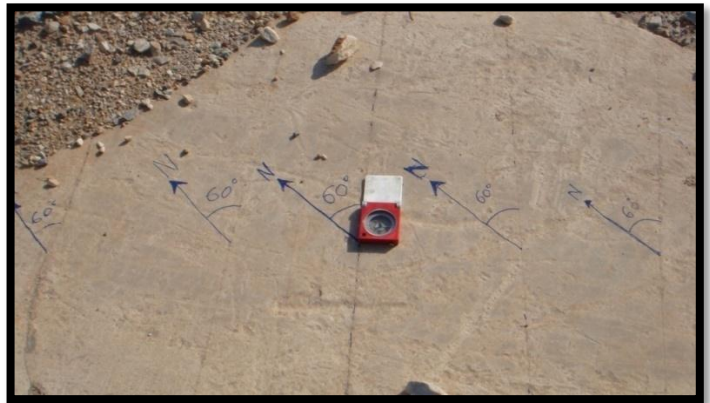
Fig.53 : Photo montrant la mesure de la fracturation apparente dans la carrière de Filfila.
