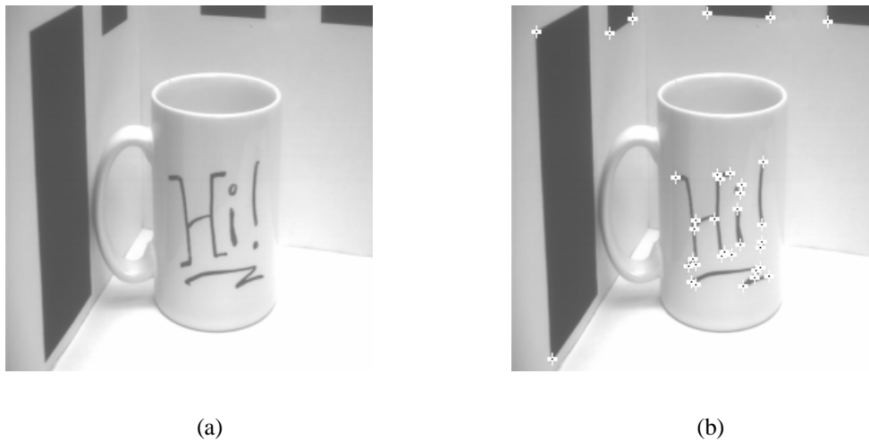
Figure 4.2 Extraction de primitives utilisant le détecteur de Harris.(a) image avant extraction, (b) image après extraction de points.
