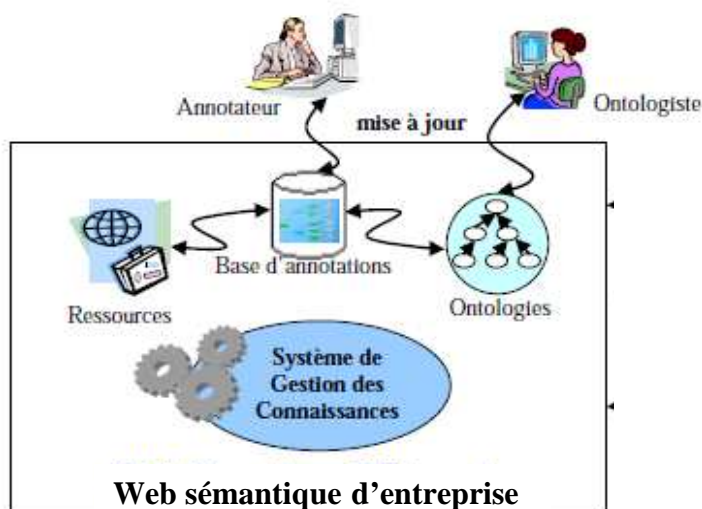
Figure 3.6 - Architecture d’un Web sémantique d’entreprise [Dieng-Kuntz et al., 2005]
