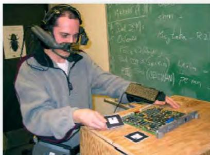
**Figure I.23. Entraînement assisté dans la maintenance d'une carte électronique d'un ordinateur**
