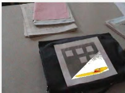
**Figure II.18. Effet d'une fausse détection des coins de l'indice sur l'augmentation obtenue: l'objet d'augmentation ne recouvre pas complètement l'indice**
