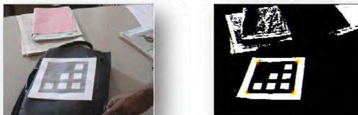
Figure II.13. Détection des coins d'un indice planaire
