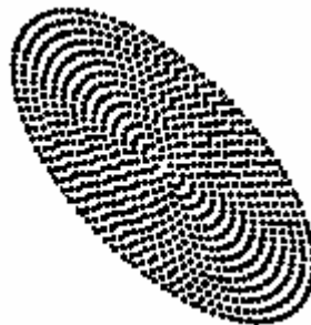
Figure V.5- Echantillonnage à l'intérieur d'une zone elliptique. Les points représentent les endroits où sont mémorisées les valeurs des niveaux de gris
