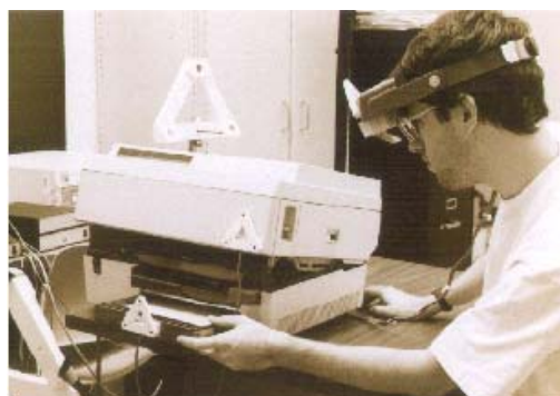
Figure II.15- Une application de RA pour la maintenance d'un photocopieur
