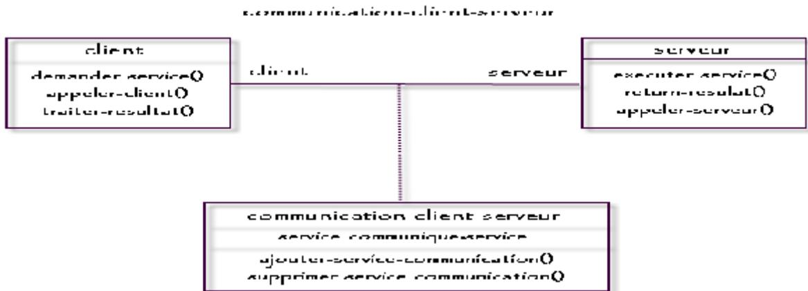
Figure 2- Modèle objet du patron client-serveur.
