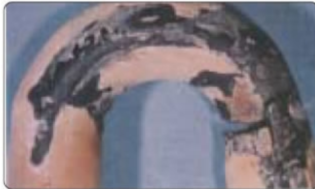
Figure 1-13- Rupture par fatigue thermique dans un secteur en U [2]
