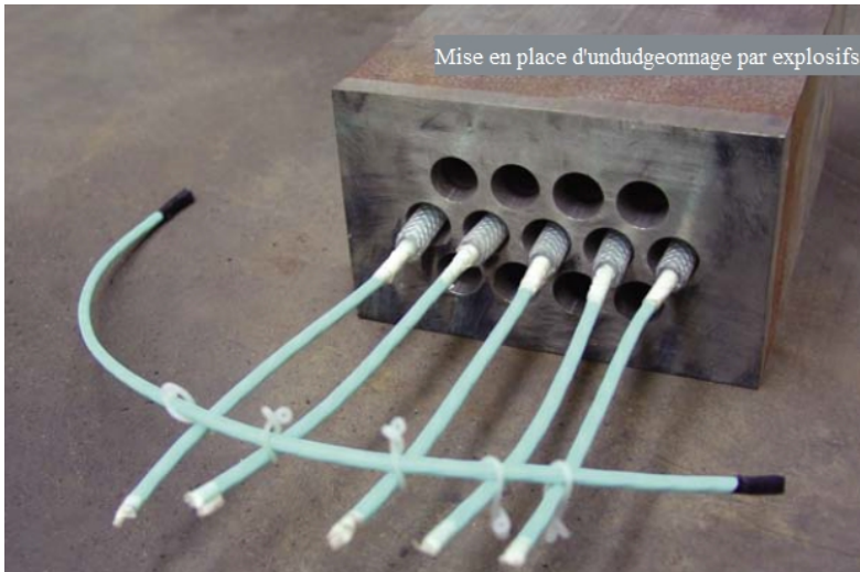
Figure 2-10 – Préparations au procédé de dudgeonnage par explosifs [5]
