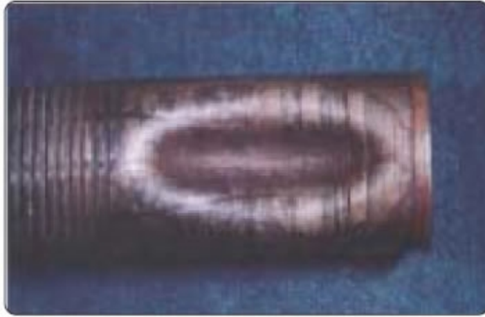
Figure 1-14- Rupture par fatigue thermique dans un secteur en U [2]
